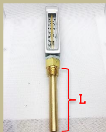
YKS-400 温度計 0~150℃ 取付ネジ PT1/2 L寸法 60/70/90/100/110/ 120 THERMOMETER
