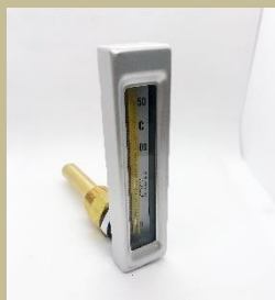
YKS-400L 温度計 0~150℃ 取付ネジ PT1/2 L寸法60/70/80 正面曲がり THERMOMETER
