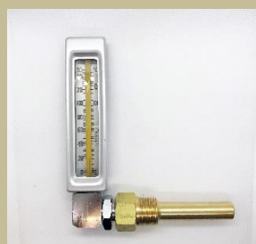
YKS-400R 温度計 0~150℃ 取付ネジ PT1/2 L寸法60/70 右曲がり THERMOMETER
